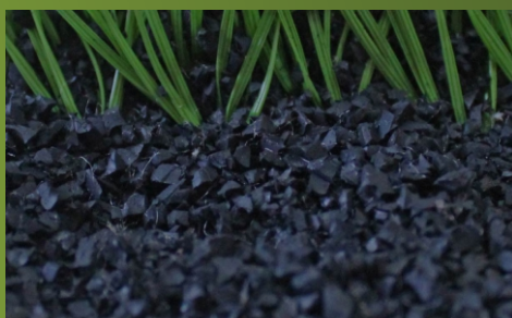
Adición Caucho Molido
